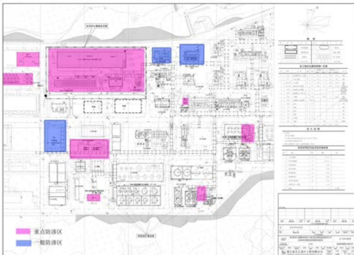
图 7.5-1 地下水分区防控图（本项目新增区域）
